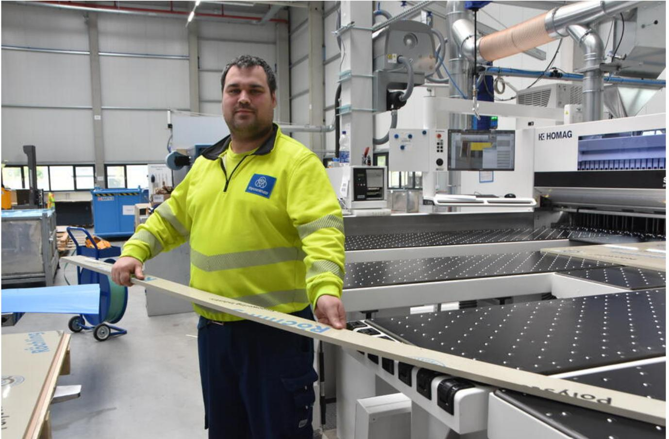
Nach speziellen Kundenwünschen werden bestellte Kunststoff-Produkte vor der Auslieferung angearbeitet. Mitarbeiter David Portelinha schneidet an der Plattensäge Kunststoffteile zu.
