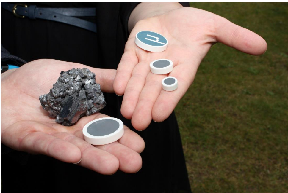
Mit einer neuen Methode werden Pulverpresstabletten als Referenzpellets hergestellt, mit denen unbekannte Materialien chemisch analysiert und bestimmt werden können. Foto: WTSH
