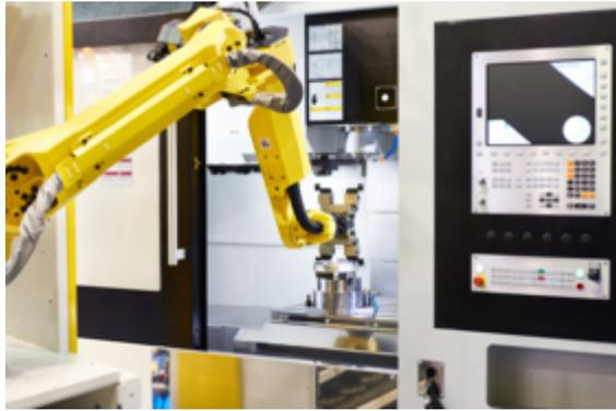
*An einer CNC-Maschine kann der Lean Roboter die richtige Taste am Bedienungsdisplay drücken, die Tür öffnen und schließen, die zu bearbeitenden Teile platzieren und fertige Teile entnehmen und in Trays setzen. Er ist auf einem fahrbaren Tisch montiert. Fotos: automate solutions*
